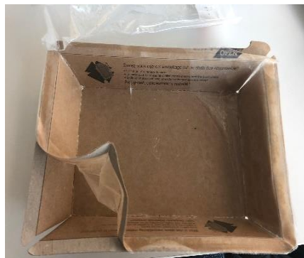
De gelamineerde laag van het karton scheiden (vb. 2)
