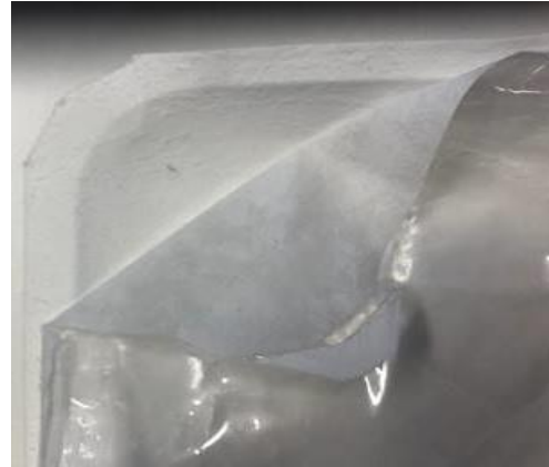
Séparation film laminé plastique du carton (ex.1)
