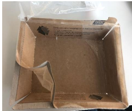
Séparation film laminé plastique du carton (ex.2)
