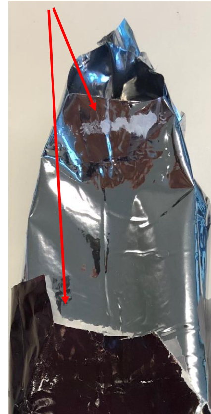
4. Peu de colle utilisée → séparation du papier et de la couche aluminium aisée
